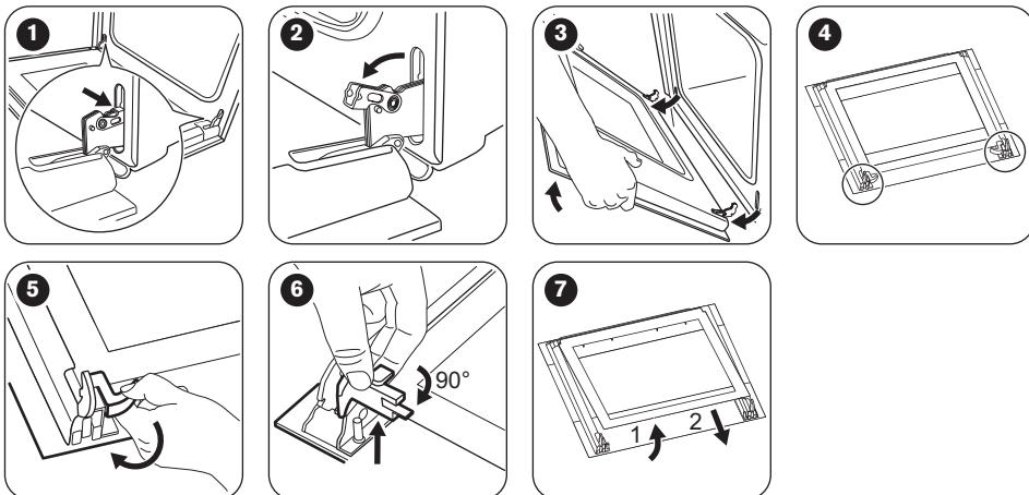
**1** Klappen Sie die Backofentür ganz auf, und greifen Sie an die beiden Türscharniere.
